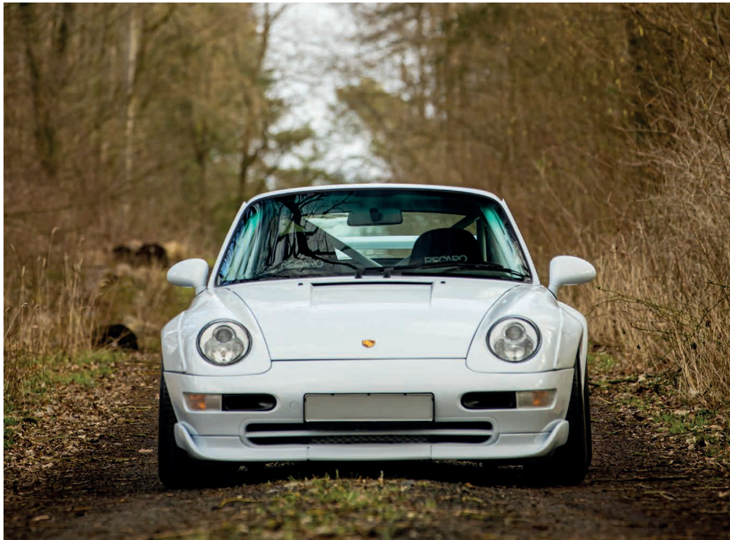
Immer Porsche: Für den Umbau wurden sowohl bei den Kotflügelverbreiterungen als auch beim Aerodynamikpaket mit Front- und Heckspoiler originale Werkteile verwendet.
