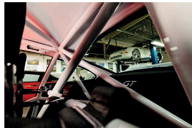
Fünfmal rund und rundum sicher: Der Armaturenräger begeistert mit den klassischen Instrumenten, für die Sicherheit sorgt ein mit der Karosserie verschweißter Überrollkäfig.
