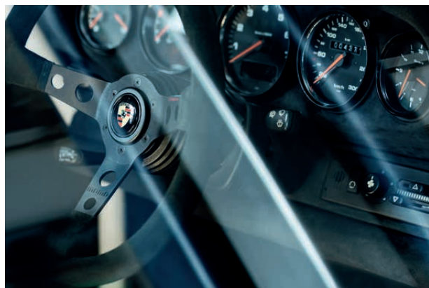
Fünfmal rund und rundum sicher: Der Armaturenräger begeistert mit den klassischen Instrumenten, für die Sicherheit sorgt ein mit der Karosserie verschweißter Überrollkäfig.
